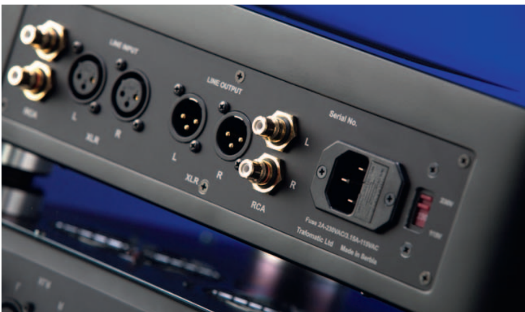
Der Head 2 kann auch als Vorstufe eingesetzt werden, bietet aber nur einen Ein-/Ausgang (XLR oder Cinch).
